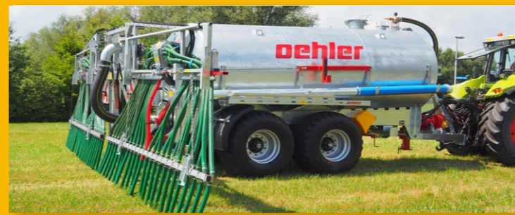
PPT 185 GFK 18.500 Liter Tandem-Pumptankwagen mit 15 mtr. Schleppschuh
