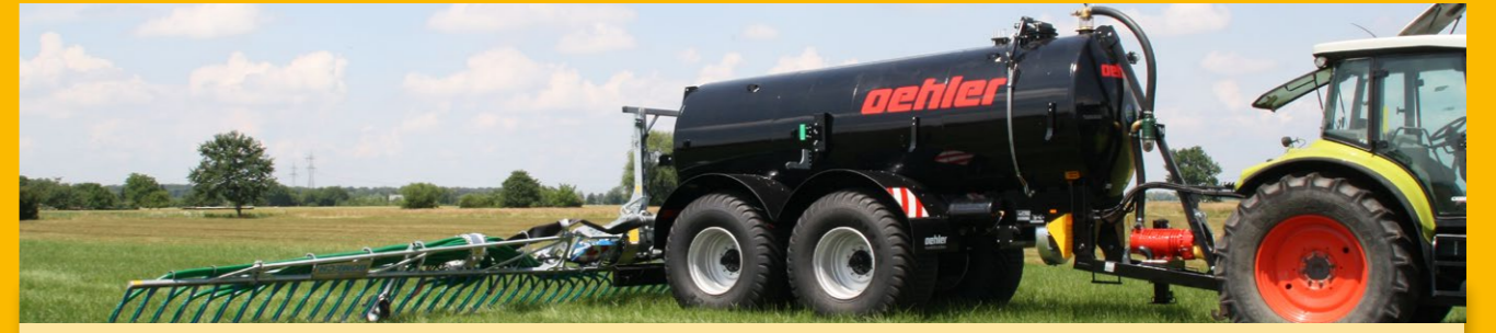
VKT 140 14.000 Liter Tandem-Vakuumtankwagen mit 15 mtr. Schleppschuhverteilung
