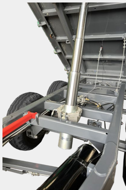
Stabiler Unterbau und Rechteckrohrrahmen
