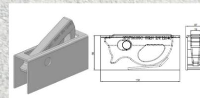
Zurröse auf Bodenplatte versenkbar
